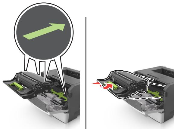
7 將碳粉匣插入印表機，插入時，請將碳粉匣邊欄上的箭頭對準印表機內側邊欄上的箭頭。
