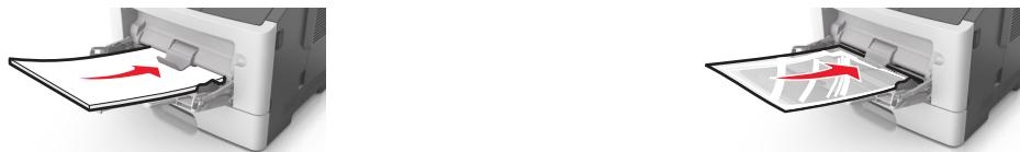
**請注意：**載入 A6 尺寸紙張時，請確認多用途送紙器的延伸組件必須輕輕靠放在紙張的邊緣，這麼做，最後幾張紙才能保持在原位。
