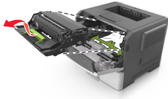
**請當心—潛藏損壞危險性：**成像組件直接曝露在光線下的時間不宜超過 10 分鐘。曝露在光線下太久，會導致列印品質發生問題。
