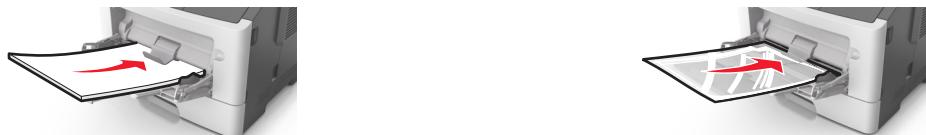
**請注意：**載入 A6 尺寸紙張時，請確認多用途送紙器的延伸組件必須輕輕靠放在紙張的邊緣，這麼做，最後幾張紙才能保持在原位。
