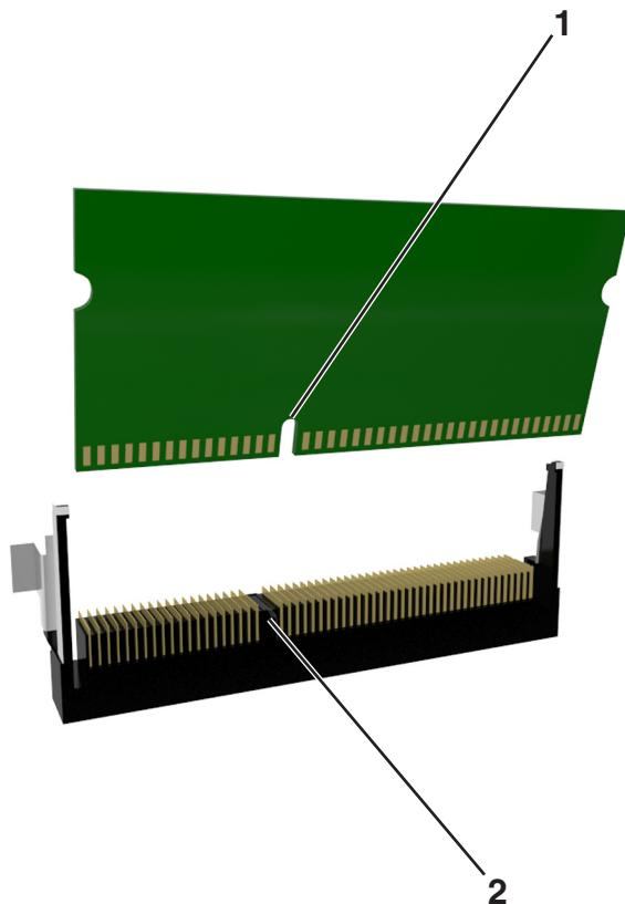
4 將記憶卡垂直推入連接器中，然後將它推入控制板內壁，直到它發出喀嚓一聲，卡入定位。
