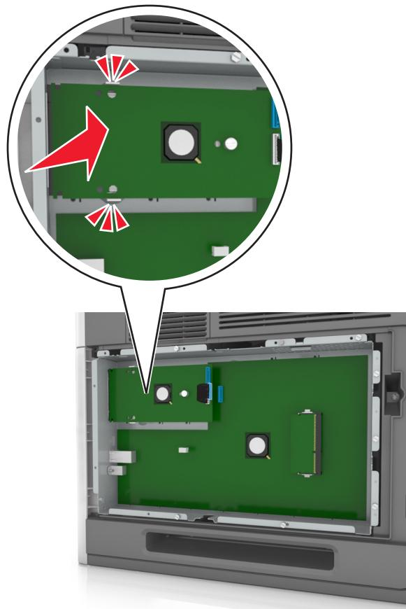
8 使用为 ISP 提供的翼形螺钉将塑料支架连接到 ISP 上。
