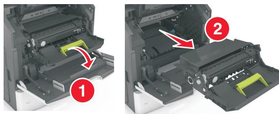
**警告—可能的损坏：**不要让成像部件暴露在直射光线下超过 10 分钟。长时间暴露在光线下可能导致打印质量问题。
