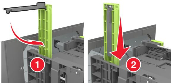
d 压住长度导片，并将它滑动到与您加载的纸张尺寸相符的正确位置上，直到它发出“咔嗒”一声，卡入到位。
