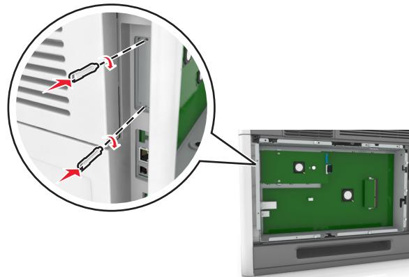
10 拧紧连接到 ISP 的翼形螺钉。
