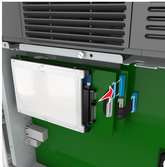
**4** 将打印机硬盘的螺孔与控制器板框架上的孔对齐，然后向下压打印机硬盘直到螺孔固定到位。
