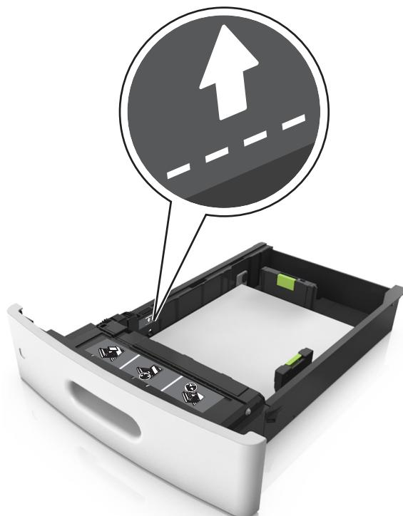
**6** 对于自定义或 Universal 尺寸纸张，请调整纸张导片到轻微接触纸堆边缘的位置，然后锁定长度导片。
