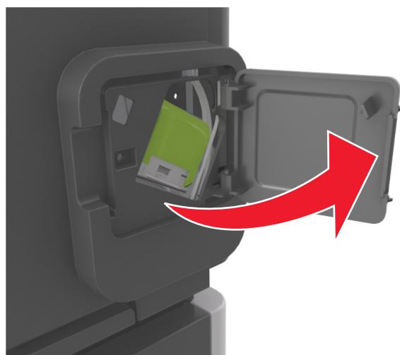
2 向下拉订书钉盒托架的插销，然后将托架从装订完成器中拉出。
