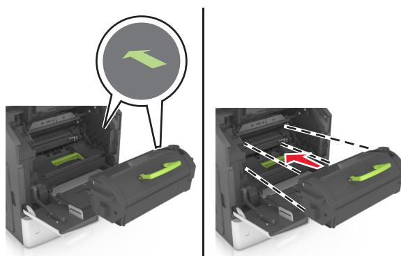
**警告—可能的损坏：**当更换碳粉盒时，不要让成像部件长时间暴露在直接的光线下。长时间暴露在光线下可能导致打印质量问题。
