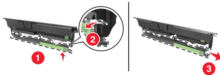
4 插入新的定影器刷片凸片的左边，穿过盖板框架左边的槽。
