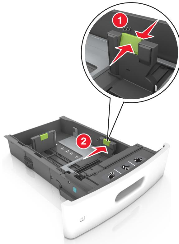
**注意：**请使用进纸匣底部的纸张尺寸指示器来帮助放置导片。
