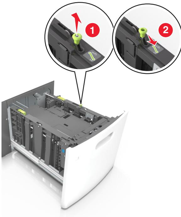
**b** 压住长度导片并将它滑动到 A5 的位置，直到它发出“咔嗒”一声，卡入到位。
