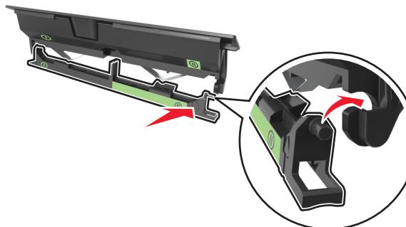
**6** 将盖板配件安装到打印机中。
