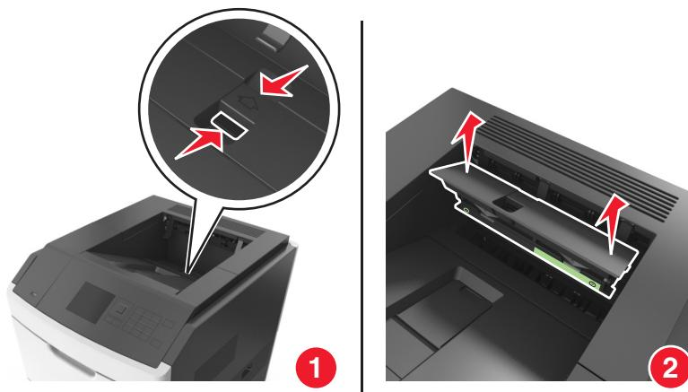
3 对着定影器刷片盖板按压定影器刷片的绿色部分，然后从盖板框架上脱开刷片的右边以移除定影器刷片。
