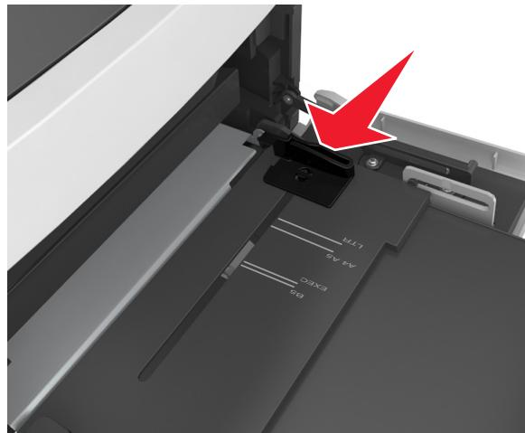
**注意:** 请使用进纸匣底部的纸张尺寸指示器来帮助放置导片。
