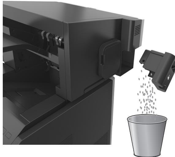
3 將清空的打孔箱裝回分頁裝訂器組件，直到它發出喀嚓一聲， 卡入定位。
