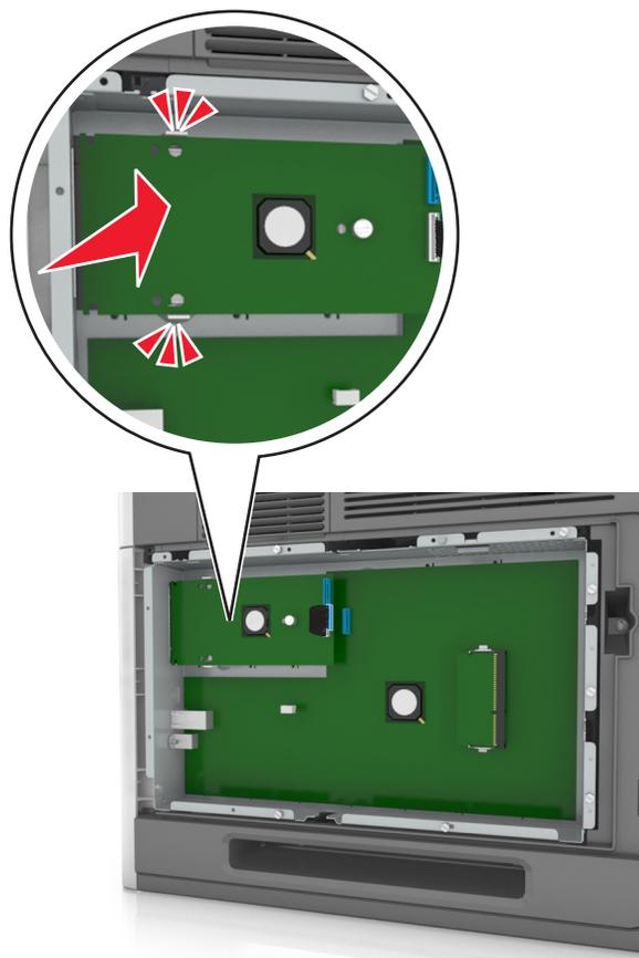
**8** Utilizzare la vite fornita per fissare la staffa in plastica all'ISP.
