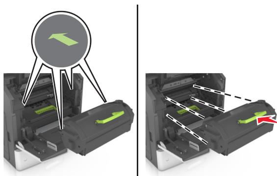
**Attenzione - Possibili danni:** Quando si sostituisce una cartuccia di toner evitare di esporre l'unità immagini alla luce diretta per un periodo di tempo prolungato. L'eccessiva esposizione alla luce può compromettere la qualità di stampa.
