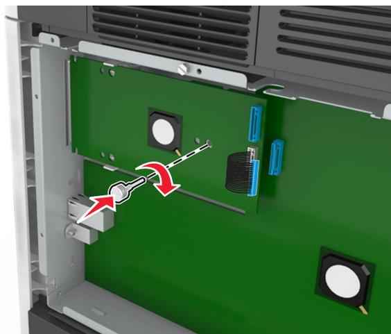
**Nota:** Ruotare la vite in senso orario in modo da tenere l'ISP in posizione, ma non serrare ancora la vite.
