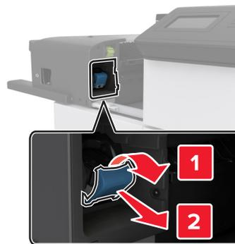
**4** Heben Sie den Heftklammerschutz mit Hilfe der Metalltasche hoch, und entfernen Sie anschließend alle losen Heftklammern.
