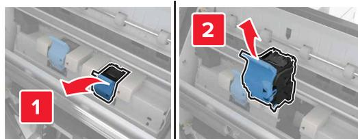
**3** Entfernen Sie die leere Heftklammerkassette aus dem Heftklammerhalter.
