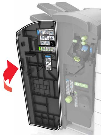
**2** Retire y vac e la caja del perforador.
