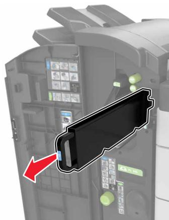
**3** Vuelva a colocar la caja del perforador.
