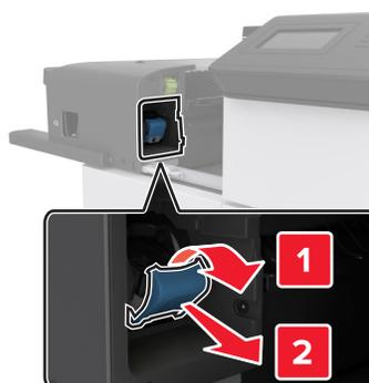
**4** Utilice la lengüeta metálica para levantar la protección de grapas y extraiga las grapas sueltas que queden.
