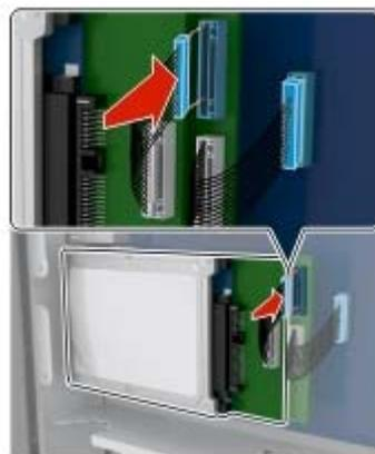
要将硬盘直接安装到控制器板罩上：
