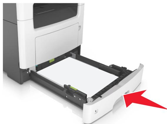
**7** 从打印机控制面板，在“纸张”菜单中设置纸张尺寸和纸张类型以匹配进纸匣中加载的纸张。
