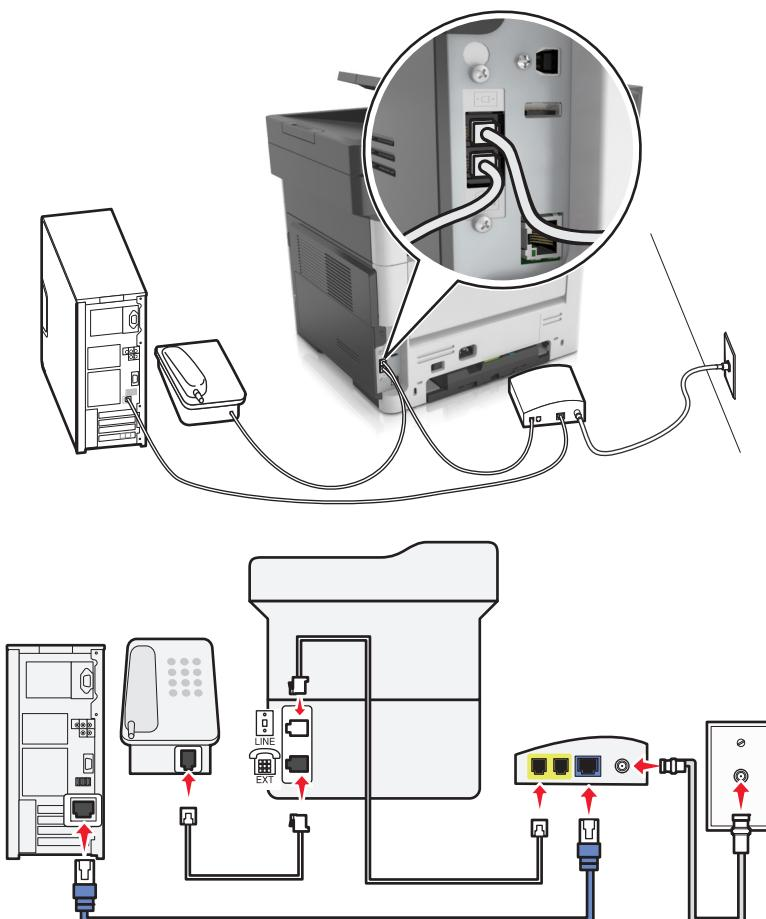
**1** 将电话线的一端连接到打印机的线路端口。
