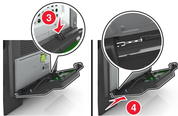
**11** 将 ISP 电缆穿过控制器板挡板。
