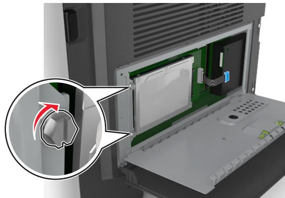
4 关闭控制器板挡板，然后关闭控制器板通道盖门。
