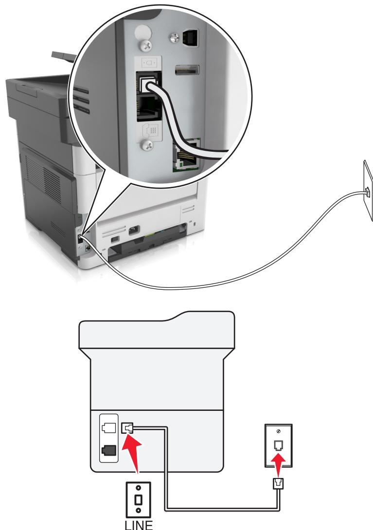
**1** 将电话线的一端连接到打印机的线路端口。
