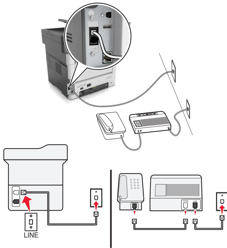
**1** 将电话线的一端连接到打印机的线路端口。
