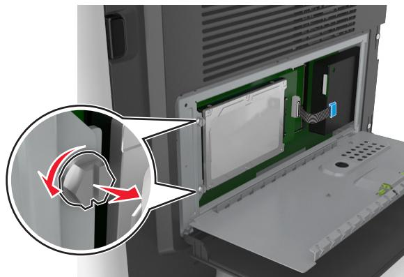
**3** 从控制器板内的插座拔掉打印机硬盘接口电缆，让电缆仍然连接在打印机硬盘上。为拔掉电缆，请在拉出电缆之前捏住接口电缆插头上的销子来释放插销。
