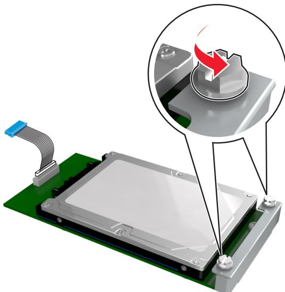
**b** 将打印机硬盘接口电缆的插头插入控制器板的插座中。
