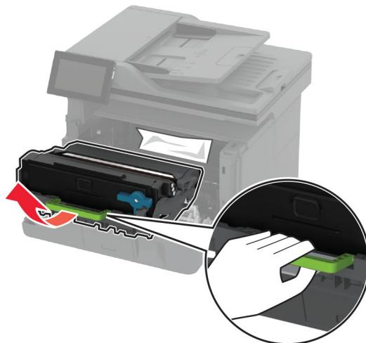
**Upozorenje—potencijalno oštećenje:** Ne izlažite ispisnu jedinicu izravnom svjetlu na duže od 10 minuta. Duže izlaganje svjetlu može uzrokovati probleme s kvalitetom ispisa.
