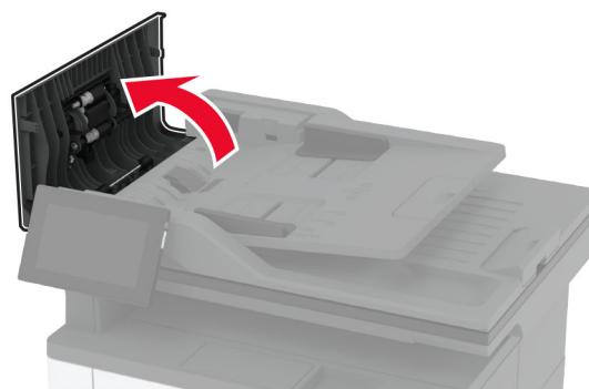
2 Izvadite iskorištenu podlogu ADF-a za odvajanje.
