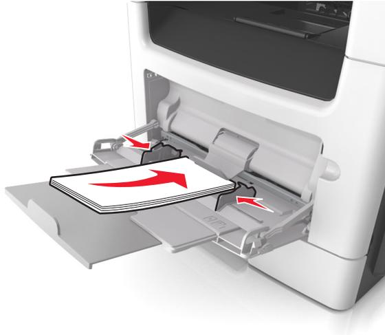
**Advertencia: Posibles daños:** No utilice nunca sobres con sellos, cierres, broches, ventanas, revestimientos oleosos o autoadhesivos. Este tipo de sobres pueden causar un grave deterioro en la impresora.
