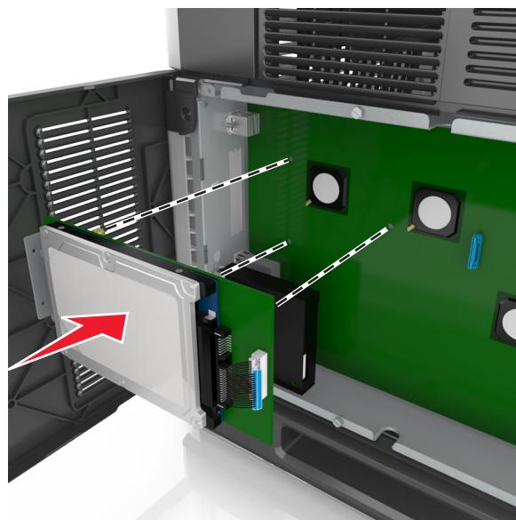
**b** 使用提供的两个螺钉以连接打印机硬盘固定板。
