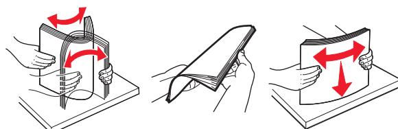
**4 加载纸张，一面打印时让可打印面朝下。**
