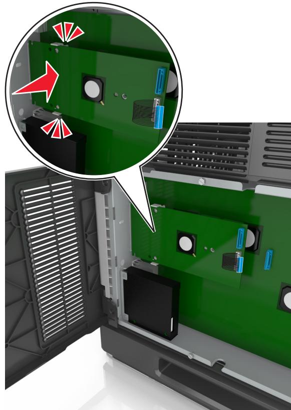
8 使用为 ISP 提供的翼形螺钉将塑料支架连接到 ISP 上。
