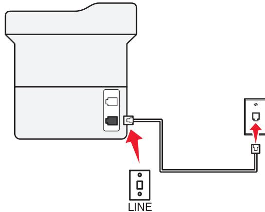
**1** 将电话线的一端连接到打印机的线路端口。
