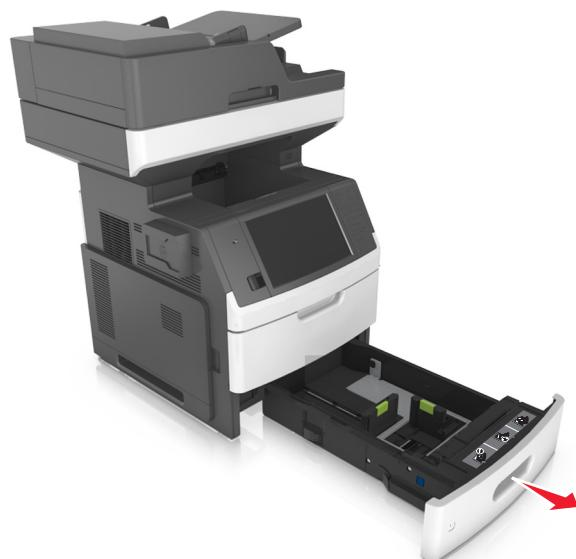
**2** 压住宽度导片，并将它滑动到与您加载的纸张尺寸相符的正确位置上，直到它发出“咔嗒”一声，卡入到位。
