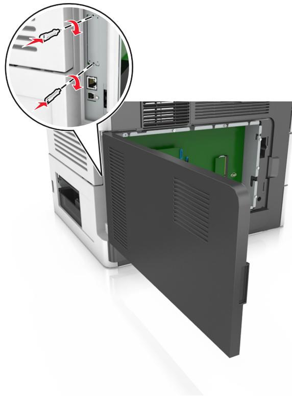
**10** 拧紧连接到 ISP 的翼形螺钉。
