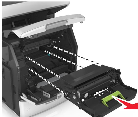
**警告—可能的损坏：**不要让成像部件暴露在直射光线下超过 10 分钟。长时间暴露在光线下可能导致打印质量问题。
