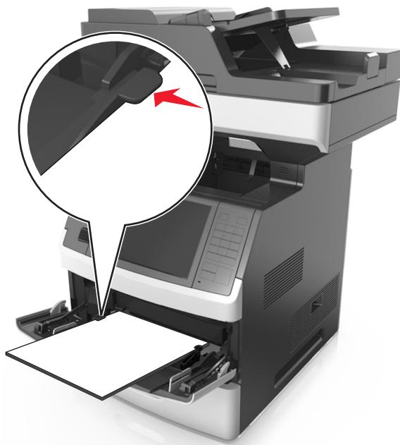
**6** 对于自定义或 Universal 尺寸纸张，调整宽度导片以轻轻地接触到纸张的边缘。
