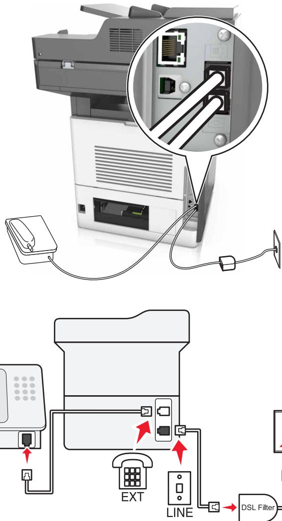
数字用户线 (DSL) 将您的常规电话线路分为两个通道：语音和 Internet。电话和传真信号通过语音通道传输，而 Internet 信号通过另一个通道传输。
