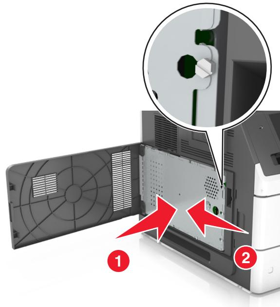
6 將防護蓋上的螺絲鎖緊。
