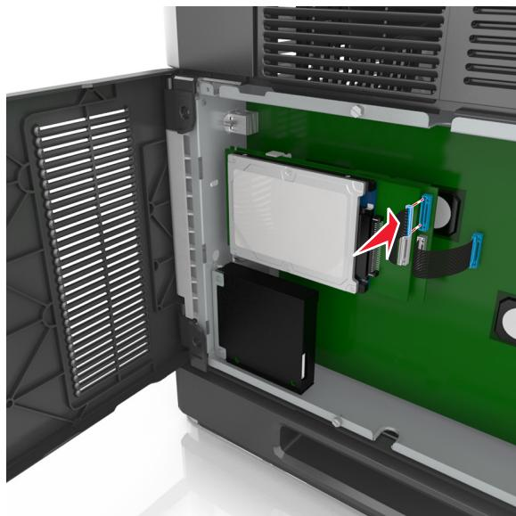
若要將印表機硬碟直接安裝在控制板箱匣上：
