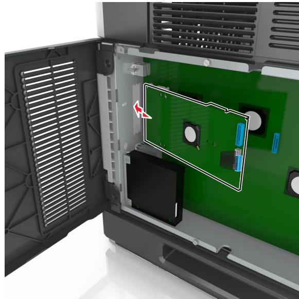
請注意：以某個角度將 ISP 擺放至塑膠支架上方，使懸空的所有連結器，都能穿過箱匣中的 ISP 開口處。
