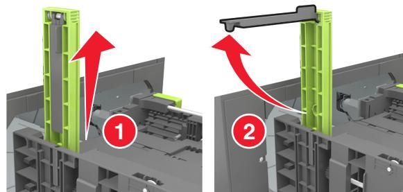
**d** 將 A5 長度導引夾插入它的指定插槽。
