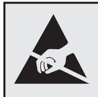
本符號指出易受靜電傷害的組件。請先觸摸印表機的金屬框架，再觸摸這些符號的附近區域。
