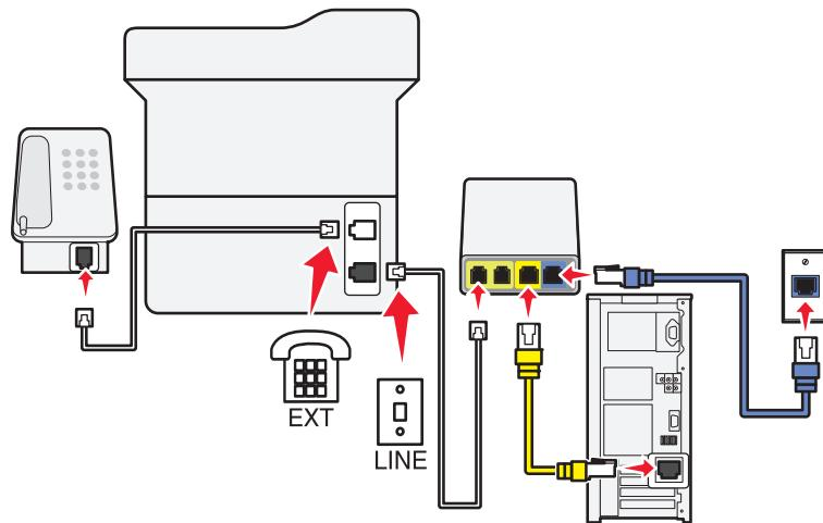
1 將電話線的一端連接到印表機的線路連接埠。
