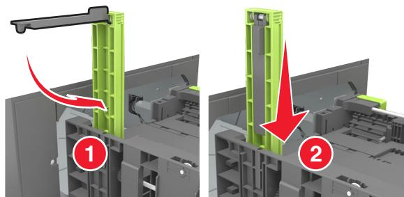
d 根據您所載入的紙張尺寸，捏住後移動長度導引夾，然後滑至正確的位置。
