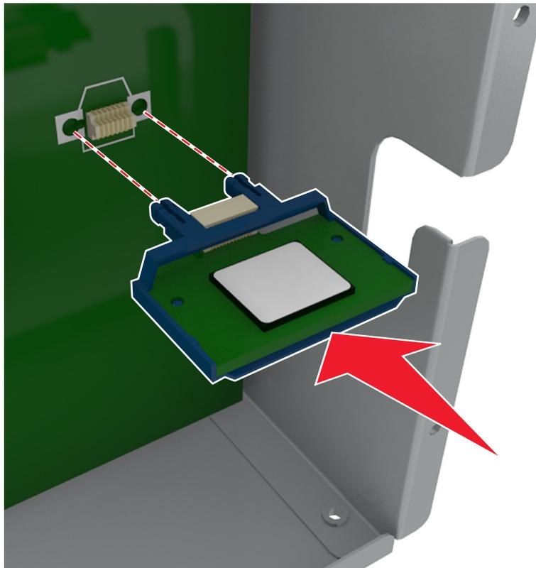
**Warnung—Mögliche Schäden:** Wird die Karte nicht ordnungsgemäß installiert, kann dies u. U. zu Beschädigungen der Karte und der Controller-Platine führen.
