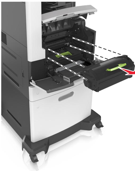
**3** Heben Sie den grünen Hebel an und ziehen Sie dann die Belichtungseinheit aus dem Drucker heraus.
