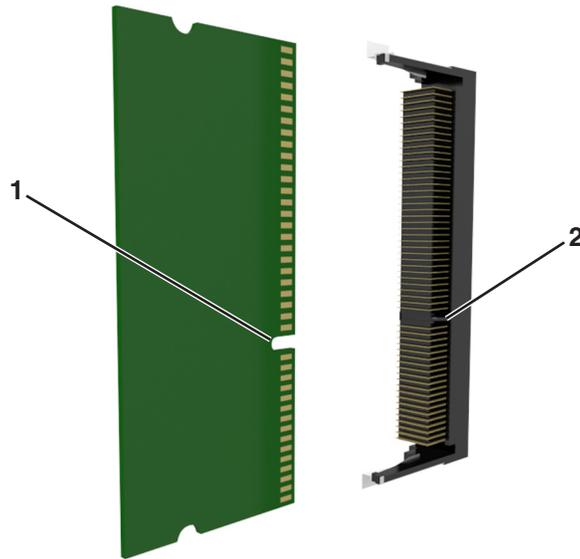
**4** Drücken Sie die Speicherkarte gerade in den Steckplatz und schieben Sie die Karte dann in Richtung der Controller-Platinenwand, bis sie hörbar einrastet.
