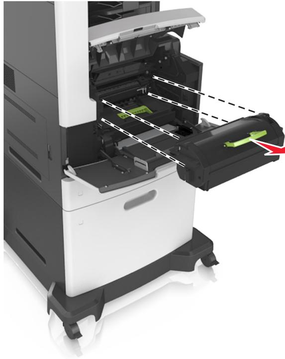
**3** Entfernen Sie die Belichtungseinheit.
