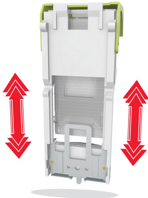
**6** Setzen Sie die Halterung der Heftklammerkassette ein.
