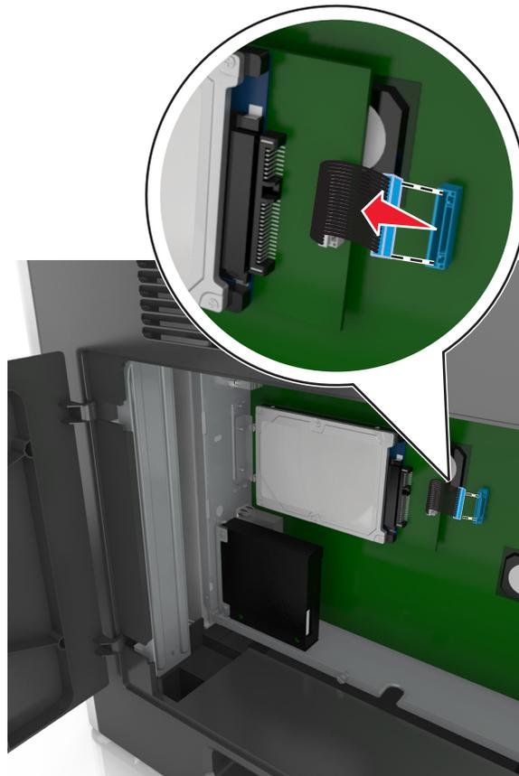
**3** Entfernen Sie die Schrauben, mit denen die Druckerfestplatte befestigt ist.
