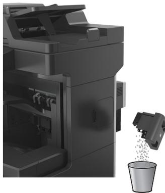
**3** Setzen Sie den Locherbehälter so in den Finisher ein, dass er *einrastet*.
