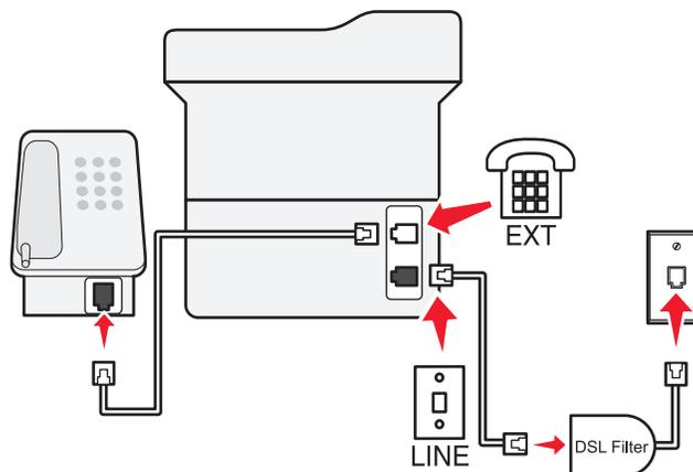
Durch DSL wird Ihre normale Telefonleitung in zwei Kanäle unterteilt: Sprache und Internet. Telefon- und Faxsignale nutzen den Sprachkanal, während Internetsignale den anderen Kanal verwenden.
