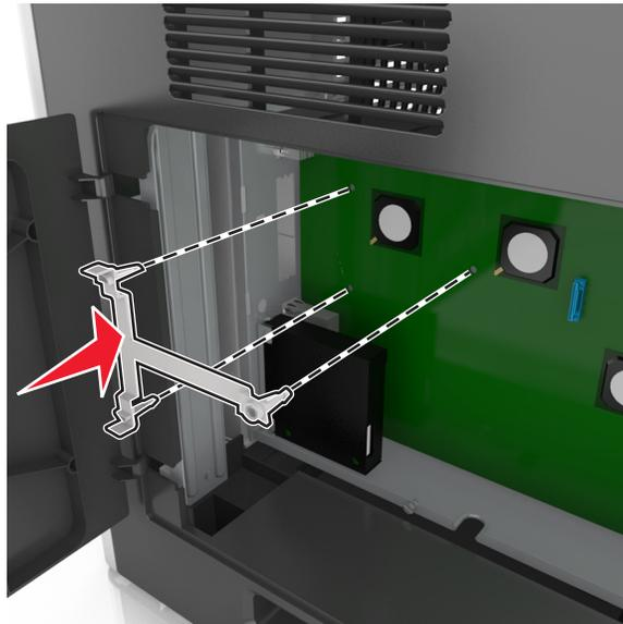
**Hinweis:** Stellen Sie sicher, dass die Kunststoffhalterung vollständig eingerastet und die Kunststoffhalterung sicher am Rahmen befestigt ist.
