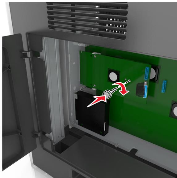
**Hinweis:** Drehen Sie die Schraube im Uhrzeigersinn, um den ISP zu befestigen, aber ziehen Sie sie noch nicht fest.
