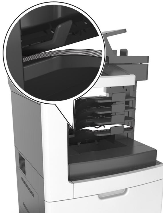
**Hinweis:** Wenn sich das Papier nicht unter dem Ablagearm befindet, tritt ein Papierstau aufgrund einer überfüllten Ablage auf.
