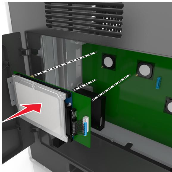
6 Вставьте два прилагаемых винта для закрепления держателя жесткого диска принтера.
