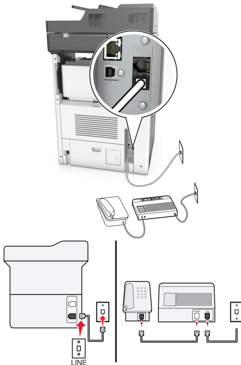
**1** Подсоедините один конец телефонного кабеля к линейному порту принтера.
