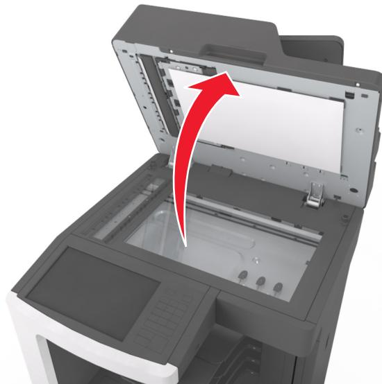
**3** Снимите белую нижнюю сторону крышки сканера.
