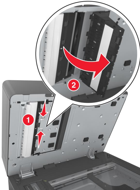
5 Протрите стекло сканера устройства автоматической подачи под дверцей УАП.
