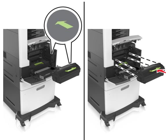
**8** Закройте дверцу многоцелевого устройства подачи и переднюю крышку.
