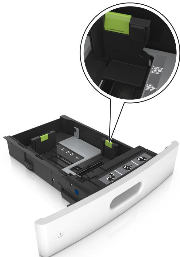
**3** Разблокируйте направляющую длины, сожмите, а затем задвиньте вспомогательную направляющую длины в правильное положение для загружаемого формата бумаги.
