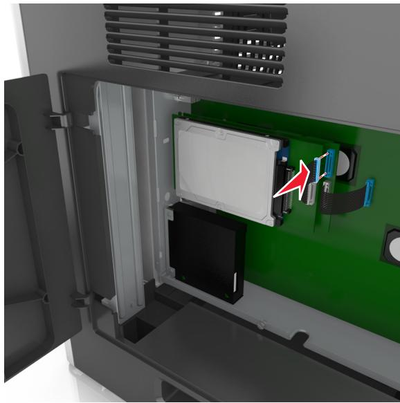
Чтобы установить жесткий диск принтера непосредственно в системную плату:
