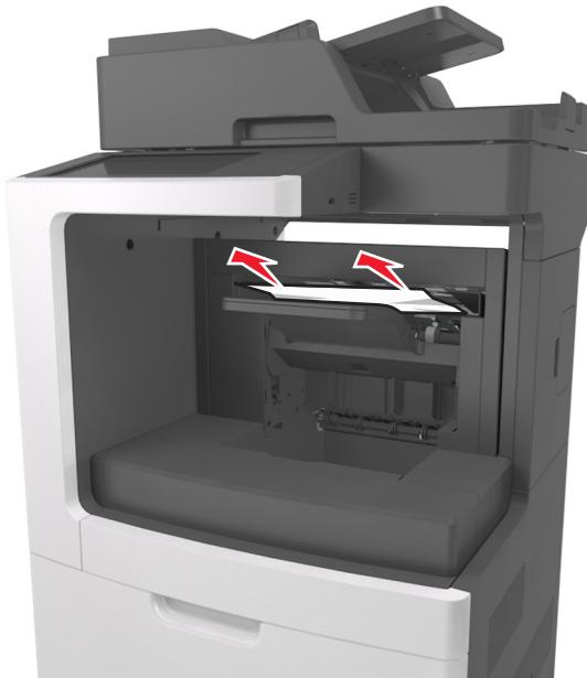
**2** Откройте заднюю дверцу брошюровщика со сшиванием, затем извлеките замятую бумагу.
