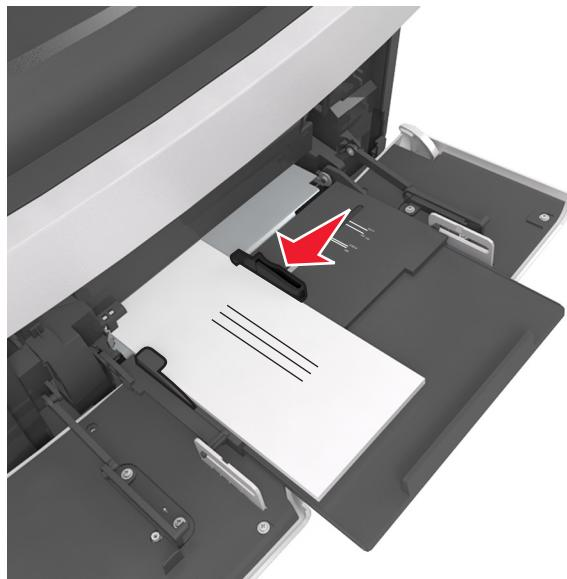
**Предупреждение – Риск повреждения!** Запрещается печатать на конвертах с марками, застежками, защелками, окнами, рельефным покрытием и самоклеящимися полосками. Такие конверты могут серьезно повредить принтер.
