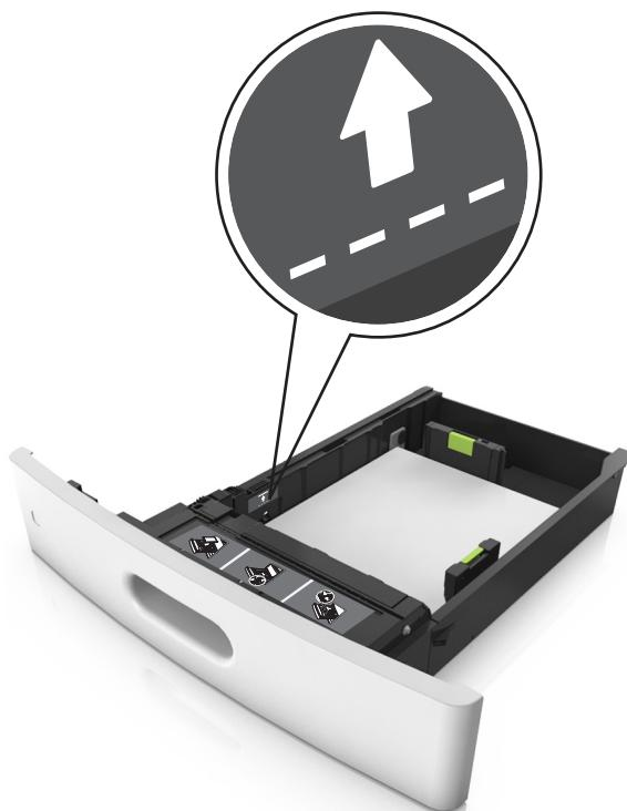
**6** Для бумаги пользовательского или формата Universal отрегулируйте положение направляющих бумаги, чтобы они слегка касались стопки и зафиксируйте направляющую длины.
