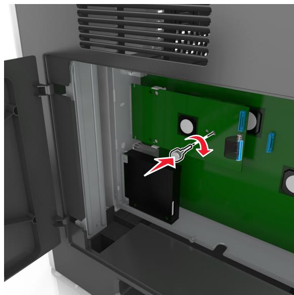
**Примечание:** Поверните винт по часовой стрелке, достаточно для того, чтобы закрепить ISP на месте, но не затягивайте его.
