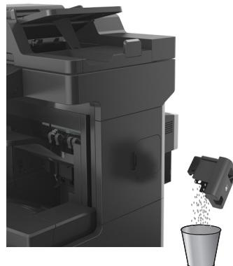
3 將清空的打孔箱裝回分頁裝訂器組件，直到它發出喀嚓一聲， 卡入定位。
