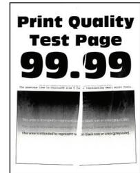
**ملاحظة:** قبل حل المشكلة، اطبع صفحات اختبار جودة الطباعة. من لوحة التحكم، انتقل إلى الإعدادات < استكشاف الأخطاء وإصلاحها < صفحات اختبار جودة الطباعة. في طرازات الطابعات المزودة بشاشات لا تعمل باللمس، اضغط على  للتنتقل عبر الإعدادات.
