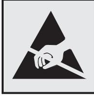
هذا الرمز يحدد الأجزاء الحساسة للكهرباء الاستاتيكية. لا تلمس المناطق القريبة من هذه الرموز دون لمس سطح معدني أولاً في منطقة بعيدة من الرمز. لتجنب حدوث تلف ناجم عن التفريغ الكهربائي عند تنفيذ مهام الصيانة مثل إزالة انحشار الورق أو استبدال المستلزمات، المس أي إطار معدني مكشوف للطابعة قبل الوصول إلى المناطق الداخلية في الطابعة أو لمسها حتى إذا لم يكن الرمز موجوداً.
