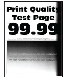
**ملاحظة:** قبل حل المشكلة، اطبع صفحات اختبار جودة الطباعة. من لوحة التحكم، انتقل إلى الإعدادات > استكشاف الأخطاء وإصلاحها > صفحات اختبار جودة الطباعة. في طرازات الطابعات المزودة بشاشات لا تعمل باللمس، اضغط على
