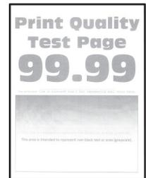
ملاحظة: قبل حل المشكلة، اطبع صفحات اختبار جودة الطباعة. من لوحة التحكم، انتقل إلى الإعدادات < استكشاف الأخطاء وإصلاحها < صفحات اختبار جودة الطباعة. في طرازات الطابعات المزودة بشاشات لا تعمل باللمس، اضغط على
