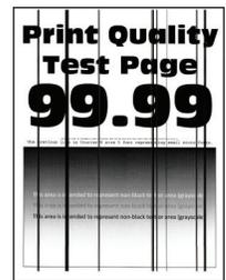
**ملاحظة:** قبل حل المشكلة، اطبع صفحات اختبار جودة الطباعة. من لوحة التحكم، انتقل إلى الإعدادات < استكشاف الأخطاء وإصلاحها < صفحات اختبار جودة الطباعة. في طرازات الطابعات المزودة بشاشات لا تعمل باللمس، اضغط على
