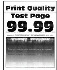
**ملاحظة:** قبل حل المشكلة، اطبع صفحات اختبار جودة الطباعة. من لوحة التحكم، انتقل إلى الإعدادات > استكشاف الأخطاء وإصلاحها > صفحات اختبار جودة الطباعة. في طرازات الطابعات المزودة بشاشات لا تعمل باللمس، اضغط على
