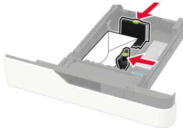
**Avertissement—Danger potentiel** : n'utilisez pas d'enveloppes avec timbre, agrafe, fermoir, fenêtre, revêtement intérieur couché ou bande autocollante.
