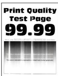
**Merk:** Før du løser problemet, skriv ut testsider. Gå til **Innstillinger > Feilsøking > Skriv ut testsider** fra kontrollpanelet. For skrivermodeller uten berørings skjerm trykker du på
