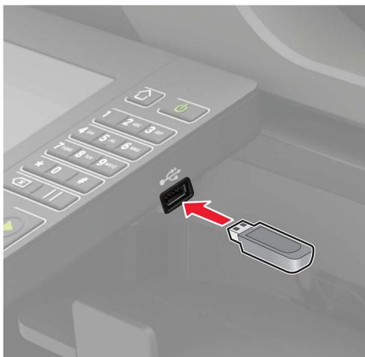
**3** Toque em **Digitalizar para USB** e ajuste as configurações, se necessário.
