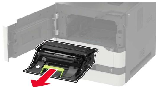
4 Uklonite iskorišćeni valjak za prenos.
