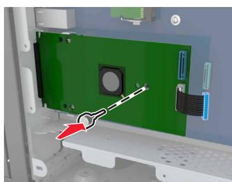
**5** Fixez le support de montage du module ISP au boîtier de la carte contrôleur à l'aide des vis.
