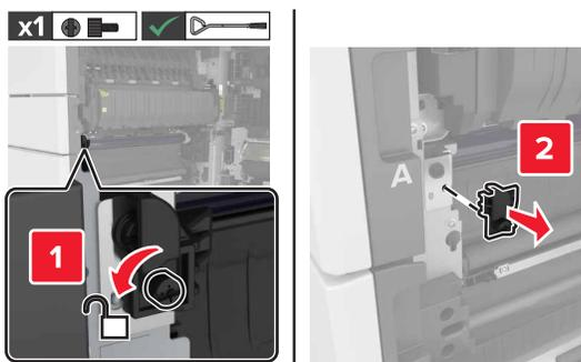
4 Desserrez les vis du verrouillage du module de transfert.
