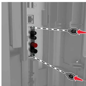
**6** Retirez les vis à ailettes qui relient le support de montage du disque dur au disque dur lui-même, puis retirez le support.
