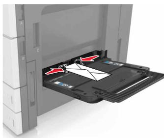
**Avertissement—Danger potentiel :** n'utilisez jamais d'enveloppes avec timbre, agrafe, fermoir, fenêtre, revêtement intérieur couché ou bande autocollante. Ces enveloppes peuvent endommager sérieusement l'imprimante.
