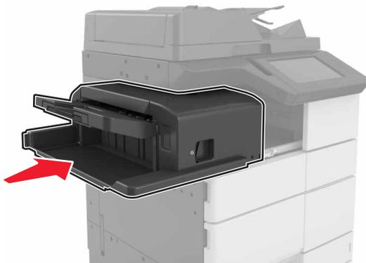
**[x]-bouchage papier, ouvrez la porte H et faites pivoter le bouton HD6 dans le sens des aiguilles d'une montre.**
