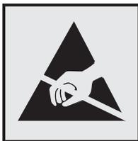
Этим знаком обозначаются компоненты, чувствительные к статическому электричеству. Перед тем, как прикасаться к поверхностям, отмеченным такими знаками, необходимо дотронуться до металлического корпуса принтера.
