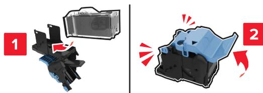
**5** Нажмите на держатель картриджа до щелчка, чтобы плотно закрепить его в брошюровщике.
