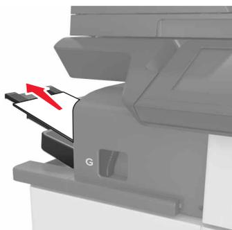
2 Нажмите на фиксатор на брошюровщике со скобами, затем сдвиньте брошюровщик влево.
