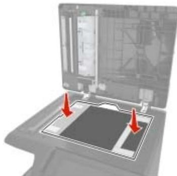
5 关闭扫描仪盖板以使 ADF 扫描垫粘到盖板上，然后打开盖板。
