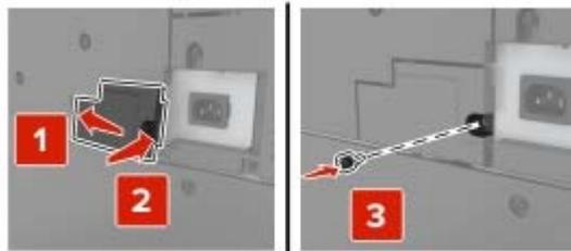
12 将电源线连接到打印机和电源插座上。
