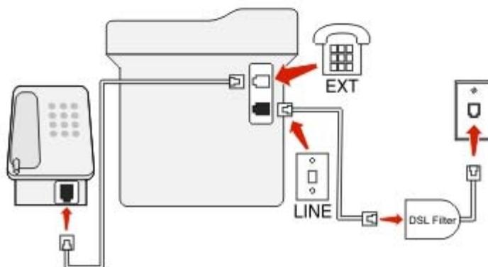
数字用户线 (DSL) 将您的常规电话线路分为两个通道：语音和 Internet。电话和传真信号通过语音通道传输，而 Internet 信号通过另一个通道传输。
