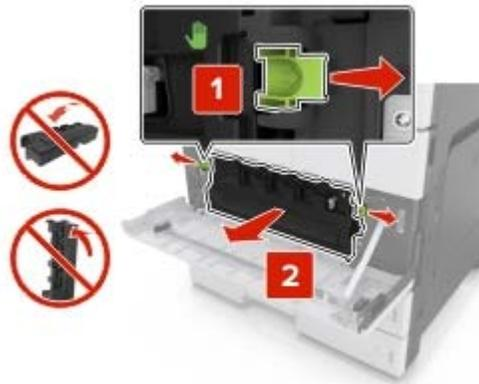
3 清洁充电辊和打印头镜片。如需更多信息，请参阅第 190 页上的“[清洁充电辊和打印头镜片](#)”的第 3-7 步。
