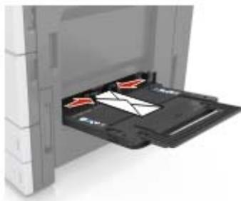
**警告—可能的损坏：**永远不要使用带有邮票、卡扣、摺扣、窗口、涂层或自动粘胶的信封。这些信封可能会严重损坏打印机。
