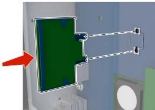
**警告—可能的损坏：**不正确安装卡可能造成卡和控制器板的损坏。
