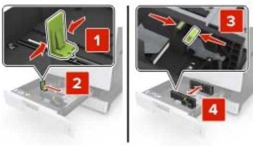
**注意：** 请使用进纸匣底部的指示线来放置导片。
