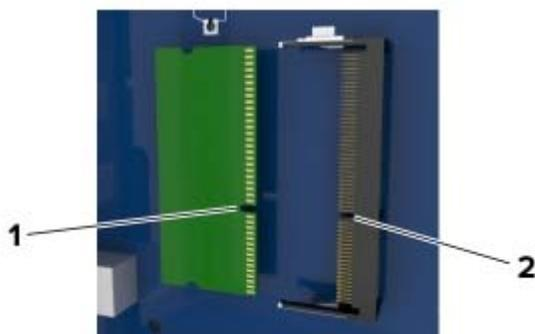
4 将内存卡笔直推入连接器中，然后将卡朝着控制器板墙推，直到它发出 *咔嚓* 一声，卡入到位。
