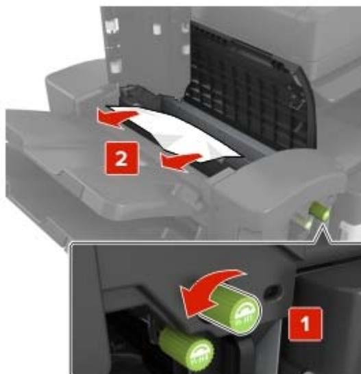
**注意：** 如果在完成器接纸架之间有卡住的纸张，请移除纸张。
