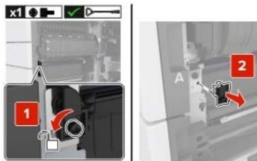
4 松开转印模块锁的螺钉。
