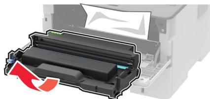
**Upozorenje – potencijalno oštećenje:** Jedinicu za izradu slika nemojte da izlažete direktnom svetlu duže od 10 minuta. Produženo izlaganje svetlu može da uzrokuje probleme sa kvalitetom štampe.
