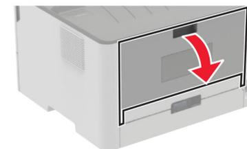
2 Otvorite vrata za pristup jedinici za nanošenje tonera.
