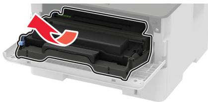
3 Uklonite iskorišćeni kertridž sa tonerom iz jedinice za izradu slika.
