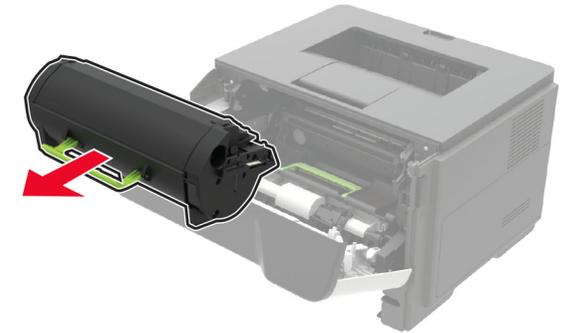
4 Entfernen Sie die Belichtungseinheit.
