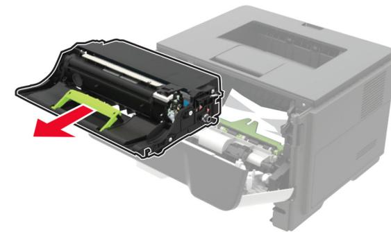
**Upozorenje – potencijalno oštećenje:** Jedinicu za izradu slika nemojte da izlažete direktnom svetlu duže od 10 minuta. Produženo izlaganje svetlu može da uzrokuje probleme sa kvalitetom štampe.
