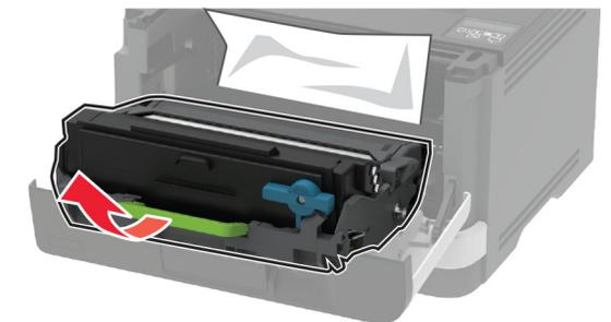
**Warnung—Mögliche Schäden:** Setzen Sie die Belichtungseinheit nicht länger als zehn Minuten direktem Licht aus. Wenn die Belichtungseinheit längere Zeit Licht ausgesetzt wird, kann dies zu Problemen mit der Druckqualität führen.
