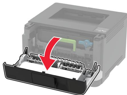
5 Uklonite jedinicu za izradu slika.
