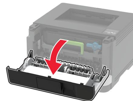
2 Uklonite jedinicu za izradu slika.
