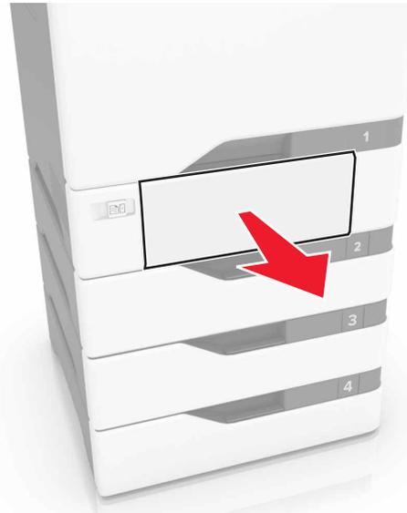
**Warnung - Mögliche Schäden:** Ein Sensor innerhalb des optionalen Fachs wird durch statische Aufladung leicht beschädigt. Berühren Sie einen Metallgegenstand, bevor Sie das verklemmte Papier in dem Fach entfernen.
