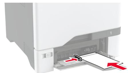
**警告—可能的损坏：**不要使用带有邮票、卡扣、摺扣、窗口、涂层或自动粘胶的信封。
