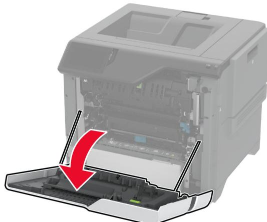
**2** Otvorte dvierka izolačnej jednotky.
