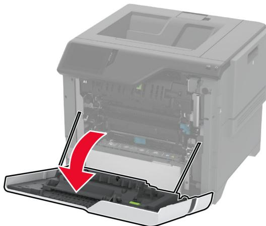
2 Otvorite vrata izolacione jedinice.
