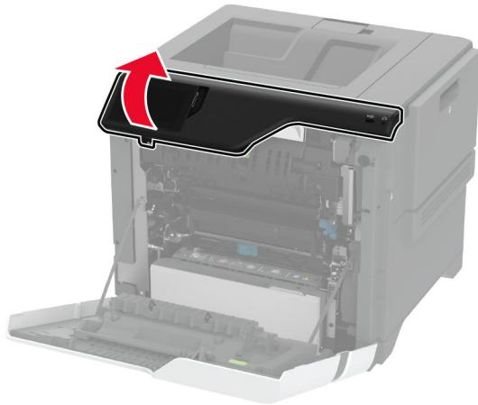
4 Otvorite vrata za pristup jedinici za nanošenje tonera.
