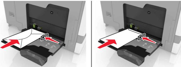
**Advarsel – mulig skade:** Ikke bruk konvolutter med frimerker, klips, klemmer, vinduer, foring eller selvklebende lim.
