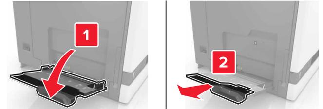
2 Passen Sie die Führung so an, dass sie dem Format des eingelegten Papiers entspricht.
