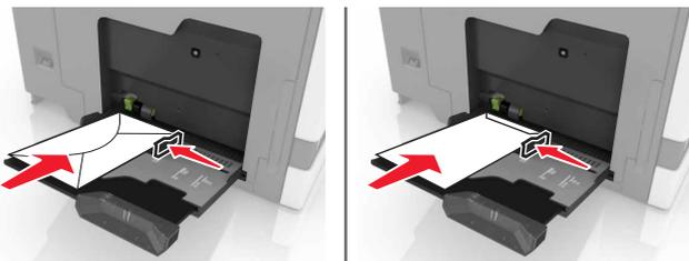
**Warnung - Mögliche Schäden:** Es dürfen keine Umschläge mit Briefmarken, Metallklammern, Haken, Fenstern, Fütterung oder selbstklebenden Klebeflächen verwendet werden.
