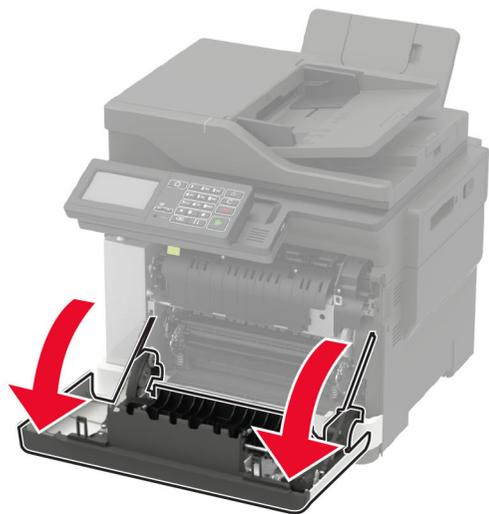
2 Otvorite pristupna vrata jedinice za nanošenje tonera, a zatim uklonite zaglavljani papir.
