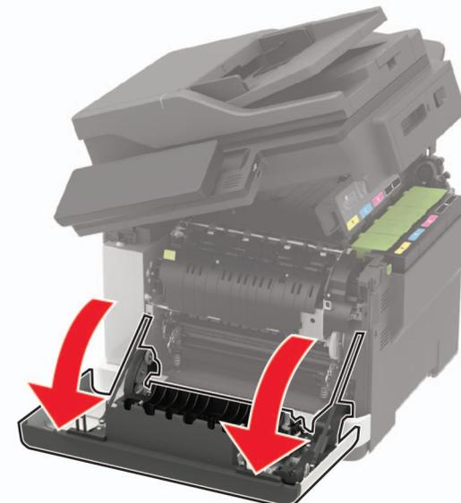
3 Otvorite pristupna vrata jedinice za nanošenje tonera, a zatim uklonite zaglavljeni papir.
