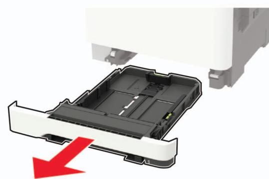
2 調整導引夾，以符合您所載入的紙張尺寸。
