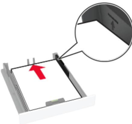
4 调整导片以匹配加载的纸张尺寸。
