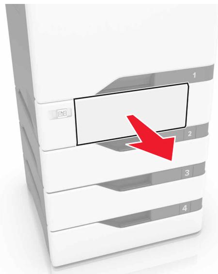
**請當心一潛藏損壞危險性：**選購性紙匣組件內的感應器很容易受靜電而損壞。移除夾在紙匣組件中的紙張之前，請先觸摸金屬表面。
