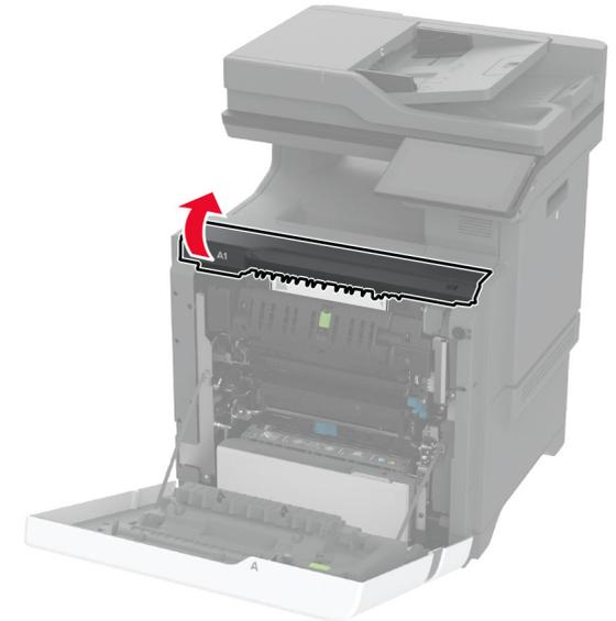
4 Öffnen Sie die Zugriffsklappe der Fixierstation.
