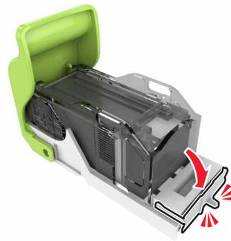
6 Setzen Sie die Halterung der Heftklammerkassette ein.
