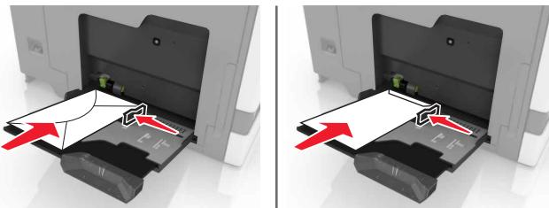
**Upozorenje—potencijalno oštećenje:** Nemojte koristiti omotnice s markicama, kopčama, spajalicama, prozorima, premazima ili samoljepljivim trakama.
