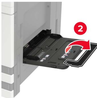
2 Reglați ghidajul pentru a se potrivi cu dimensiunea hârtiei pe care o încărcați.
