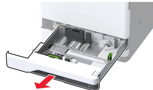
2 調整導引夾以符合您載入的紙張尺寸。
