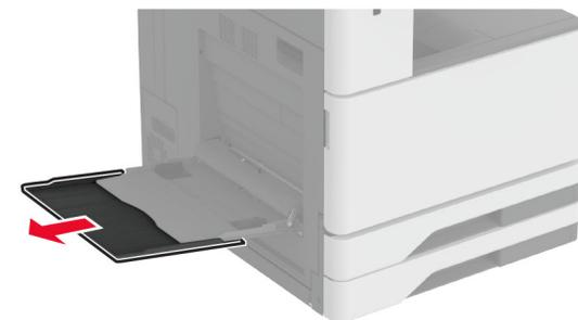
2 調整側導引夾，以符合您所載入的紙張尺寸。
