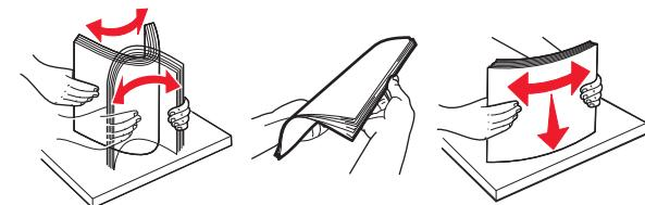
**4 让可打印面朝下加载纸张, 然后确认侧导片紧密地贴着纸张。**
