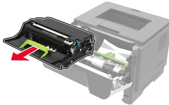
**請當心—潛藏損壞危險性：**成像組件直接暴露在光線下的時間不宜超過 10 分鐘。暴露在光線下太久，會導致列印品質發生問題。
