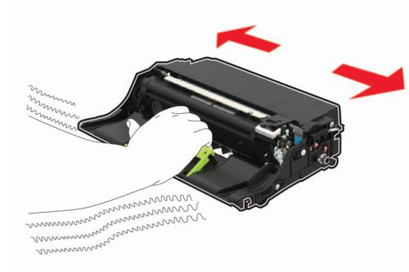
**請當心一潛藏損壞危險性：**成像組件直接曝露在光線下的時間不宜超過 10 分鐘。曝露在光線下太久，會導致列印品質發生問題。
