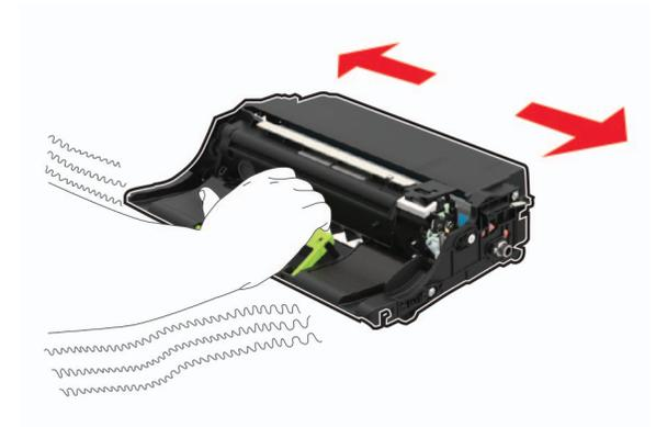
**Warnung—Mögliche Schäden:** Setzen Sie den Fotoleiter nicht länger als zehn Minuten direktem Licht aus. Wenn es zu lange dem Licht ausgesetzt ist, kann dies zu Problemen mit der Druckqualität führen.
