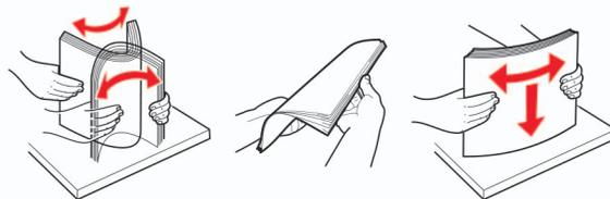
**4** Legen Sie den Papierstapel mit der zu bedruckenden Seite nach oben ein, und stellen Sie anschließend sicher, dass die seitlichen Führungen eng am Papier anliegen.
