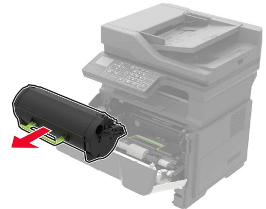
4 Entfernen Sie die Belichtungseinheit.
