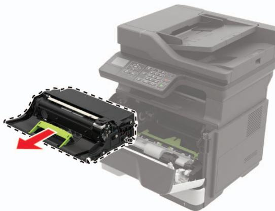
4 Распакуйте новый блок формирования изображения, а затем три раза встряхните его, чтобы распределить тонер внутри.
