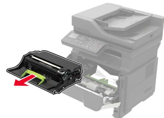
**Upozorenje – potencijalno oštećenje:** Jedinicu za izradu slika nemojte da izlažete direktnom svetlu duže od 10 minuta. Produženo izlaganje svetlu može da uzrokuje probleme sa kvalitetom štampe.
