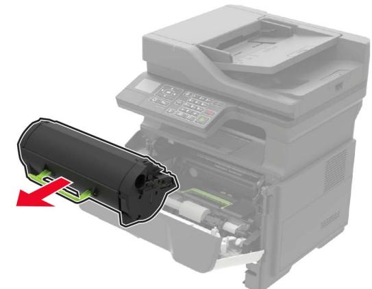
4 Uklonite jedinicu za izradu slika.
