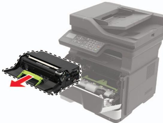
4 Otpakujte novu jedinicu za izradu slika, a zatim je protresite tri puta da biste rasporedili toner.
