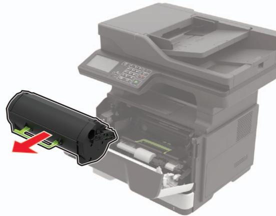
3 Entfernen Sie die gebrauchte Belichtungseinheit.
