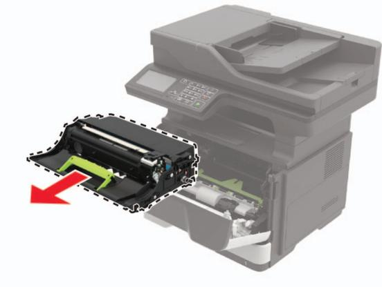
4 Nehmen Sie die neue Belichtungseinheit aus der Verpackung, und schütteln Sie sie drei Mal, um den Toner zu verteilen.
