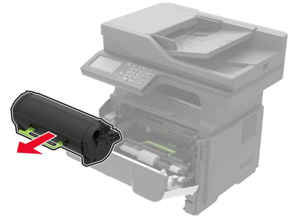
4 Entfernen Sie die Belichtungseinheit.
