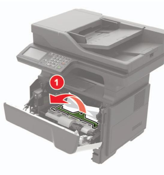
6 Setzen Sie die Belichtungseinheit ein.
