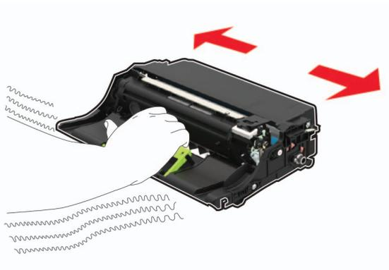
**請當心—潛藏損壞危險性：**成像組件直接曝露在光線下的時間不宜超過 10 分鐘。曝露在光線下太久，會導致列印品質發生問題。
